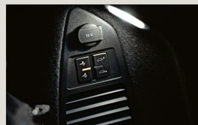
Coffre à bagages: l'attelage de remorque peut être déployé en appuyant sur un bouton. (MICHELE LIMINA)
